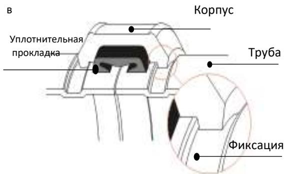
При удалении валиков сварного шва или выступов с уплотнительной поверхности трубы, следите за тем, чтобы не отшлифовать поверхность больше, чем необходимо. После шлифовки всегда наносите подходящее антикоррозийное покрытие на этот участок.
